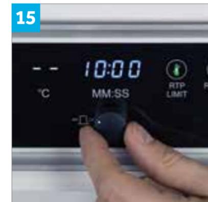
15 Configure en el generador la duración deseada
