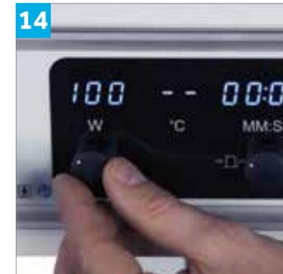
14 Configure en el generador la potencia deseada
