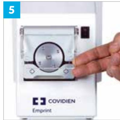
5 Abra la tapa transparente del cabezal de la bomba
